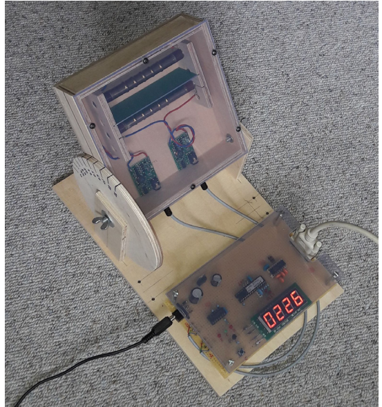
Der Cosmic-Rays-Detector mit 2 alten sowjetischen Geiger-Müller-Zählrohren
